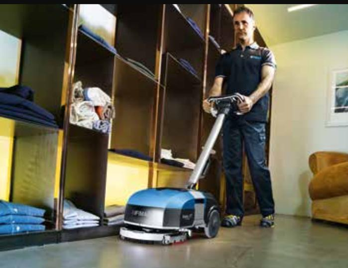
Die Bürsteneinheit verstellt sich seitlich zum Maschinengestell und ermöglicht dadurch die perfekte Reinigung entlang von Wänden. So wird die gesamte Nutzfläche des Raums hygienisch sauber.
