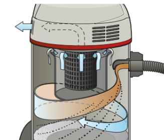
Durch den Drall am Einlassstutzen wird der Sprühnebel an der Behälterwand abgeschleudert. Zusätzliche Filterstoffe sind nicht mehr notwendig. Die zuverlässige Schwimmerabschaltung reagiert selbst bei extremer Schaumbildung. Seitliche Kühl-Luftschlitze sorgen für konsequente Trennung von Kühl- und Prozessluft.
